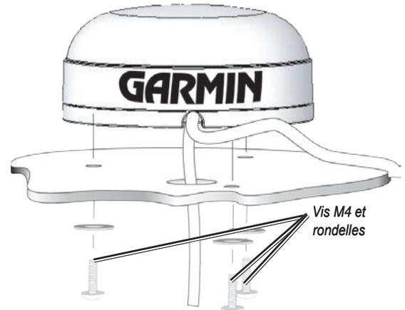
Lorsque vous installez l'antenne GPS 17, vous pouvez faire passer le câble d'alimentation à travers la surface de montage, ou hors de l'appareil. Si le câble passe à travers la surface de montage, appliquez du mastic d'étanchéité sur l'extérieur de la zone de sortie.
