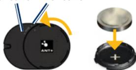
2. Tournez le cache dans le sens inverse des aiguilles d'une montre jusqu'à ce qu'il soit suffisamment desserré pour pouvoir être retiré.
