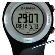
Emplacement de l'antenne
