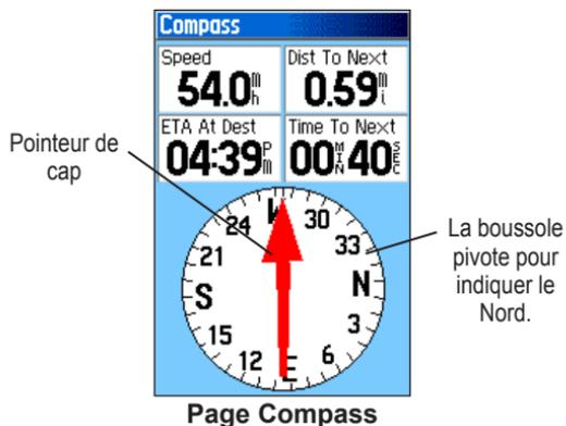
Durant la navigation, cette carte fournit des données et des instructions. La page Compass utilise une boussole, un pointeur de cap/direction et des champs numériques pour afficher des informations telles la vitesse actuelle, la distance jusqu'au prochain point et l'heure d'arrivée prévue.
