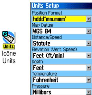
**Position Format (format de coordonnées)** – Sélectionnez le format d’affichage voulu pour les coordonnées. Le format par défaut est la latitude et la longitude en degrés, minutes et millièmes de minute (hddd°mm.mmm).
