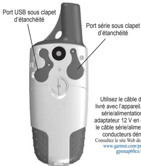
Utilisez le câble de USB livré avec l'appareil, le câble série/alimentation avec adaptateur 12 V en option ou le câble série/alimentation à conducteurs dénudés.
