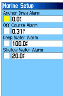
**Anchor Drag Alarm (alerte de dérive d'ancre)** – Permet de programmer une alerte sonore qui se déclenche en cas de dérive d'ancre excédant la distance spécifiée.
